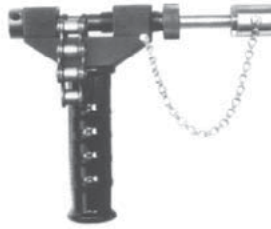
Herramienta para partir cadena. El botador de golpear va guiado por entre el pisador riscado de cabeza moleteada. Este ultimo mantiene la cadena prensada mientras se dan los golpes con el martillo y el botador.
