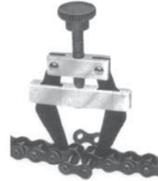
Esta herramienta se utiliza para conectar cadena. Las tenazas sostienen los dos extremos justo a la distancia para que se pueda insertar la unión. Viene e 3 tamaños.
