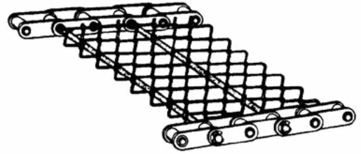
Arriba. Transportador de mallas con varillas transversales cuyos extremos van introducidos entre los pasadores huecos de dos cadenas paralelas hermanadas.
