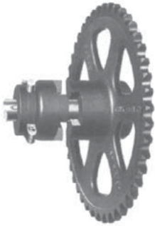
Piñón con embrague de muelas, estas con sus superficies de contacto planas y a escuadra.
